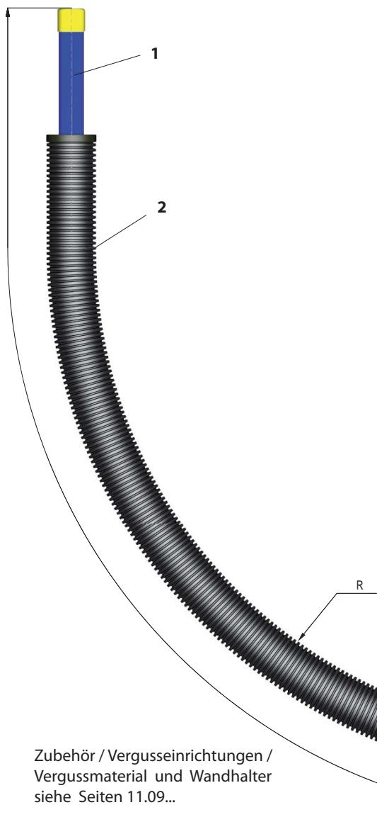
Wasser - Rohrkapseln in flexibler Ausführung.
