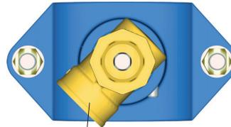
Eckventiloberteil frei um 360° schwenkbar mit zusätzlicher Fixierschraube
