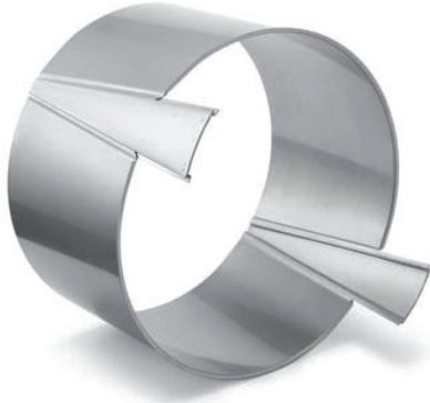
Innenstütz-Hülse mit Keilverschluss als Stützhülse für PE-Rohre nach DIN 8074, DIN 8075 und DIN 16892/93. Zum Einsatz mit Rohren aus PE 80, PE 100 in SDR 11 + 17, sowie PE-Xa für den Gas- und Wassereinsatz. Werkstoff - rostfreier Stahl (V2A) WN: 1.4301 (AISI 304).
