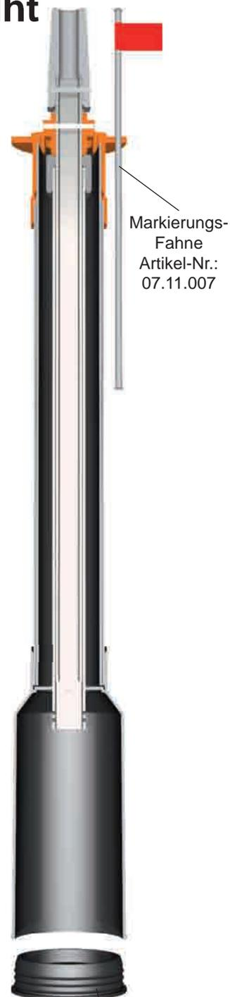
Anschlusskit: Kuppelmuffe KOS und 2 St. Klammer-Stifte zur werkzeugfreien Montage
